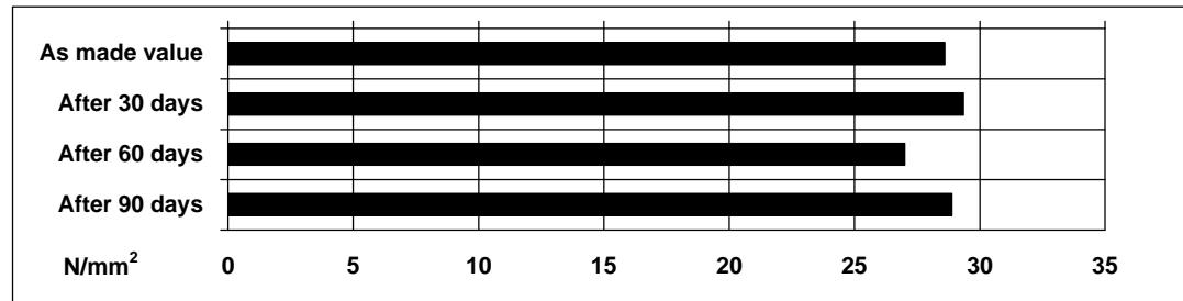
**Roller peel test (ISO 4578)**
